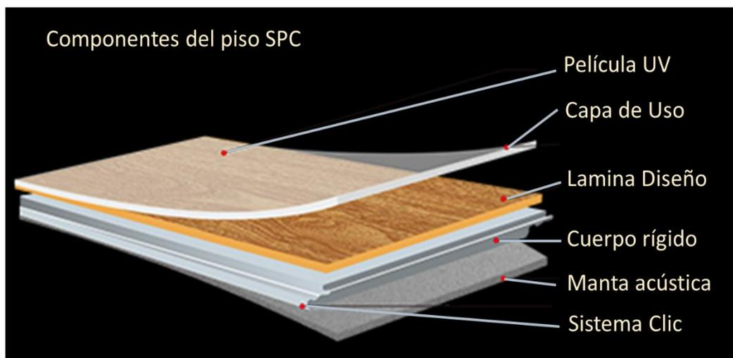
**ESPUMA IXPE (manta acústica):** Disminuye el ruido al impacto, confort al caminar, reduce imperfecciones.
