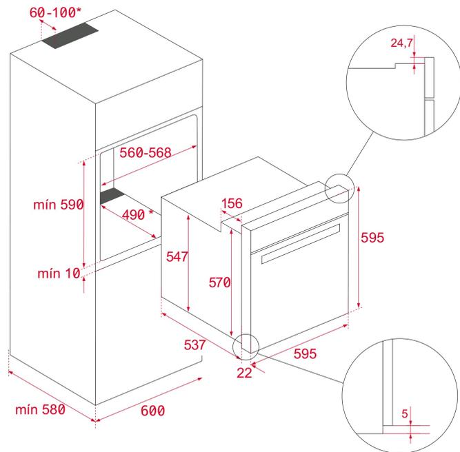
**Se requiere 2 rejillas de ventilación de 10 cm x 40 cm en la parte superior como en la parte inferior del Horno a gas para su correcto funcionamiento.**
