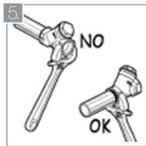
Para fines de montaje, usar una llave inglesa, aplicando torque necesario solo en el extremo del filtro más cercano a la tubería. Esto ayuda a conseguir un agarre más firme y evitar daños potenciales al cuerpo del filtro.
