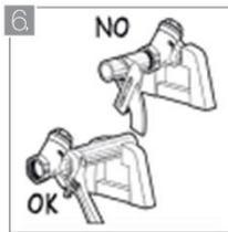
Para evitar distorsiones y daños, no poner el filtro en el banco de montaje quedese con la tubería fija en su lugar y enroscar el filtro en su lugar.
