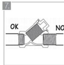
El roscado de la tubería no debe ser más largo que el de los hilos del filtro.
