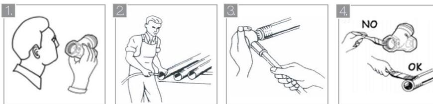
1. Antes de la instalación, inspeccionar las roscas del filtro no tenga ningún tipo de suciedad.
