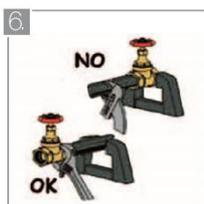
6. Con el fin de evitar posibles deformaciones y daños en partes funcionales, si se utiliza un banco de montaje, en lugar de sujetar la válvula de compuerta con mordazas se debe bloquear el tubo y enroscar a este la válvula de compuerta.
