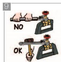
9. Para ensamblar el bonete al cuerpo de la válvula, se aconseja realizar la fijación gradualmente para evitar que la junta de estanqueidad entre las dos piezas quede sometida a esfuerzos excesivos.
