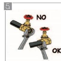
5. Para el montaje, utilizar una llave fija y no una llave para tubos aplicando el torque solo sobre la hexagonal de la válvula más cercano al tubo. De este modo, la fijación será más sólida y se evitarán posibles daños en el cuerpo de la válvula.
