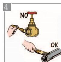
4. Aplicar el sellante solo sobre la rosca del tubo y no sobre la rosca de la válvula de compuerta.
