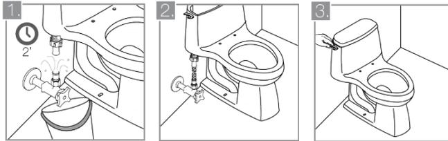
1. Conecte una manguera flexible al abasto de agua y a la válvula de llenado. Recuerde que la aplicación de presión excesiva por el uso de herramientas puede malograr las conexiones u ocasionar fugas.
