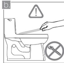
La tapa taza del sanitario puede contar con una capa plástica protectora, retírela con cuidado y sin utilizar herramientas metálicas, ya que podría rayar la superficie.
