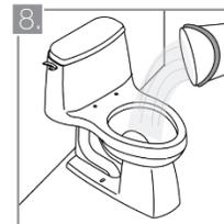
8. Descargue el contenido de un balde de agua en la taza del sanitario. Verifique que el vaciado se realiza correctamente y que no hay filtraciones bajo la taza. Realice el llenado de agua al tanque y descargue 3 veces para que no filtre debajo del tanque.
