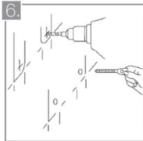
6. Pedestal corto: Perfore los orificios para el pedestal. Instale los tornillos en los orificios de la pared.
