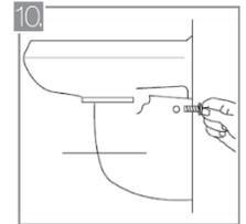
10. Pedestal corto: Inserte los pernos en los orificios del pedestal.
