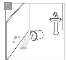
Antes de instalar el sanitario, abra la llave de paso durante dos o tres minutos y descargue tres baldes de agua para purgar los ductos de eventuales restos de obra. Verifique que la campana del desagüe tiene un diámetro de cuatro pulgadas (4") y que hay una distancia de 30.5 cm desde su eje hasta la pared instalada. Si está instalado un sanitario de reemplazo, retire cualquier resto de cera o cemento alrededor de la misma.
