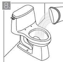
8. Descargue el contenido de un balde de agua en la taza del sanitario. Verifique que el vaciado se realiza correctamente y que no hay filtraciones bajo la taza. Realice el llenado de agua al tanque y descargar 3 veces para que no filtre debajo del tanque.
