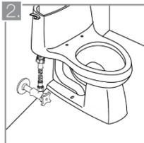
2. Tome una manguera flexible, conecte uno de sus extremos a la llave de paso y el opuesto al vástago de la válvula de llenado. Verifique que no se presentan fugas y que la válvula de descarga tiene un funcionamiento óptimo. Si su sanitario incluye un filtro para sedimentos, inclúyalo en el acople.
