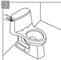
3. Cuando el sanitario se llene, realice una descarga y verifique que el vaciado se realiza con la potencia óptima, que la válvula de llenado se detiene a la altura deseada y que el espejo de agua tiene el nivel indicado.
