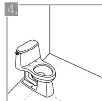
4. Ubique la taza del sanitario sobre la boca del desagüe, verificando que las marcas trazadas previamente coincidan a la perfección. Marque con lápiz los puntos destinados a los tornillos de sujeción y señálelos utilizando un punzón. Realice un orificio en cada uno de ellos con el taladro e inserte el chazo correspondiente.
