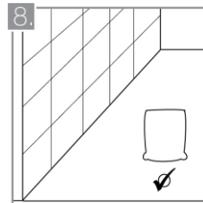
Elija una fragua que sea flexible, impermeable al agua y permeable al vapor, resistente al moho y al ataque químico.
