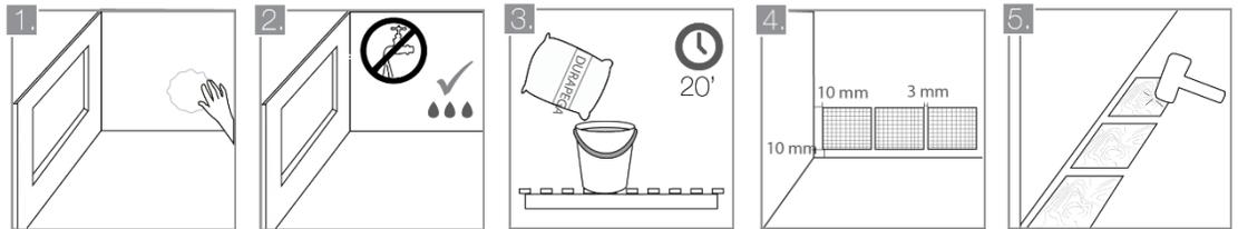
1. Antes de iniciar la instalación, limpie la superficie de soporte para eliminar el polvo y los residuos de obra, ya que estos restan adherencia al adhesivo.
