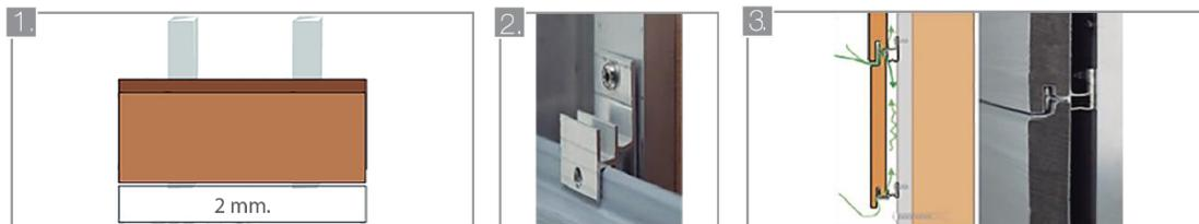
Una vez instalado el bastidor, coloque la primera línea de Clips, comenzando de abajo hacia arriba. Deje un espacio entre la tabla y el piso de 2 mm. **Nota:** Para sujetar el Clip al bastidor utilice tornillo o pija de 3/4".
