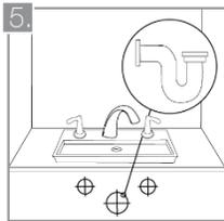
Conecte la trampa P al extremo del sifón y la boca del desagüe. Deje que el pegamento fragüe durante el tiempo especificado por su fabricante.
