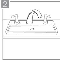
Instale las griferías antes de proseguir con la instalación de la porcelana. Recuerde que una aplicación excesiva de presión durante este paso puede ocasionar fracturas en los lavamanos.
