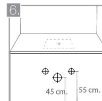
Compruebe que haya una altura de 45 cm desde el piso terminado hasta el eje de la trampa y de 55 cm desde el piso terminado hasta el eje de los puntos de agua fría y caliente.
