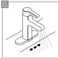
Abra las llaves de paso y las griferías. Compruebe que el agua es evacuada eficientemente, que el desagüe ha sido correctamente instalado y que el rebosadero (si lo hay) evacua el exceso de agua correctamente.
