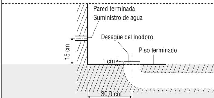
2- Coloque el sanitario en el piso con la tapatanque puesta. Ubíquelo a 1 o 2 mm de distancia de la pared. Alinéelo correctamente con respecto a la pared y proceda a marcar en el suelo la ubicación de los orificios de fijación.
