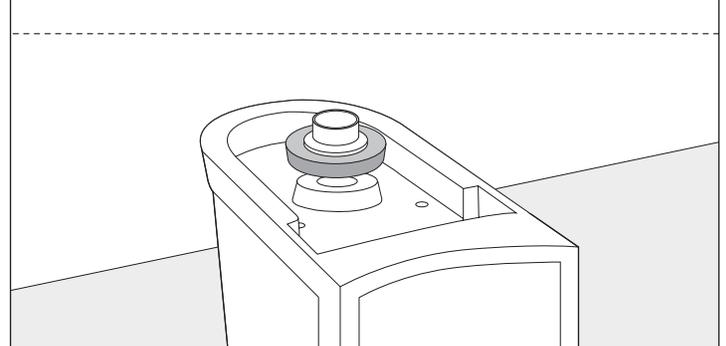
5- Conecte los sistemas de desagüe. Nivele y fije el sanitario al piso por medio de los tirafondos.
